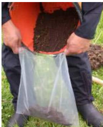
Figura 4. Forma adecuada de empaclar las muestras
