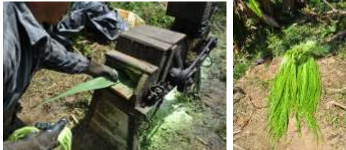
10 Introduciendo la hojas hasta tocar el guardamano – Puñado o atado de fibra al sol Fotografía: Diego Granados 2011
