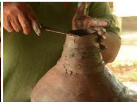
Modelado y levantamiento de la pieza
