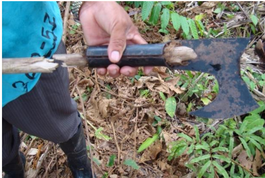
Cabo de la medialuna roto durante intento de corte de cogollo
