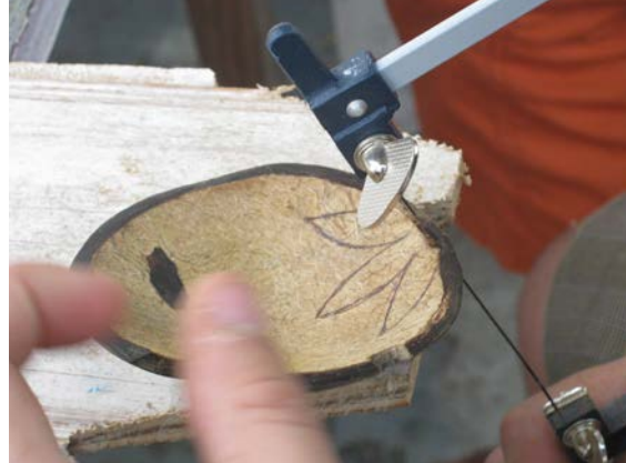
Proceso implementación del soporte de corte y proceso de calado manual.
