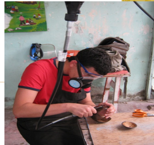
Proceso de lijado Elementos de protección personal.
