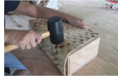
Ajuste del tejido amarrado sobre el molde y golpe con mazo para marcar dobleces
