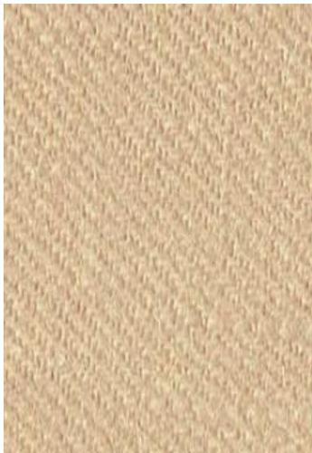
El tejido cruzado se caracteriza por las líneas diagonales muy marcadas producidas por entrelazamiento de dos hilos de la urdimbre con un hilo de la trama en filas alternadas. Esta clase de tejido proporciona a la tela una gran resistencia, útil para prendas de trabajo.
