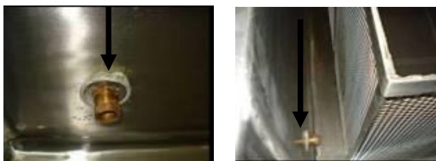
Termocupla interna de la marmita- Guadalupe, Huila - Artesanías de Colombia Fotografía: Nydia Leonor Castellanos Gasca – diciembre de 2008
