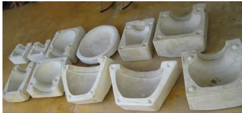
Moldes listos para trabajo con placa y presión 2015
