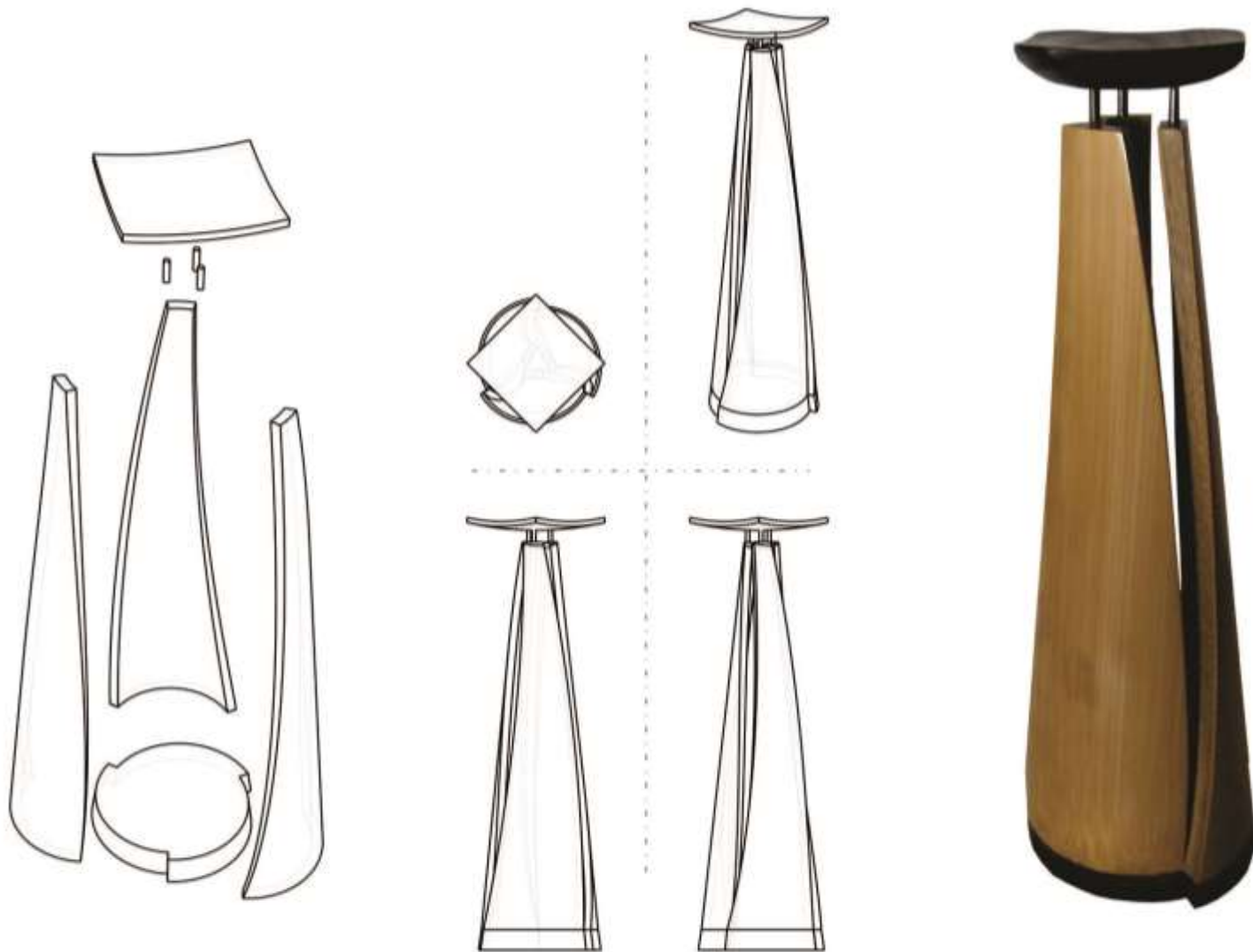
Figura 3. Candelabro seccionada. Fragmentación del canuto de guadua en 3 secciones (módulos) que se reensamblan de forma cónica junto a la madera y el acero inoxidable.
