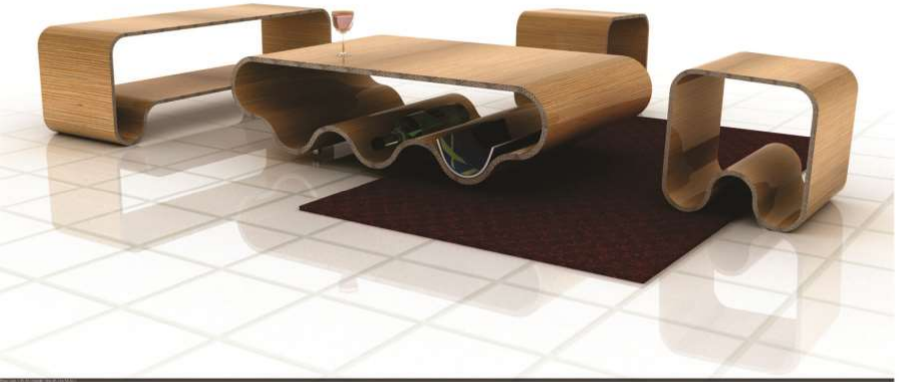
Figura 12. Render Mobiliario auxiliar en guadua. Segmentos de guadua rolliza unidos a un tablero de guadua de 3 capas.
