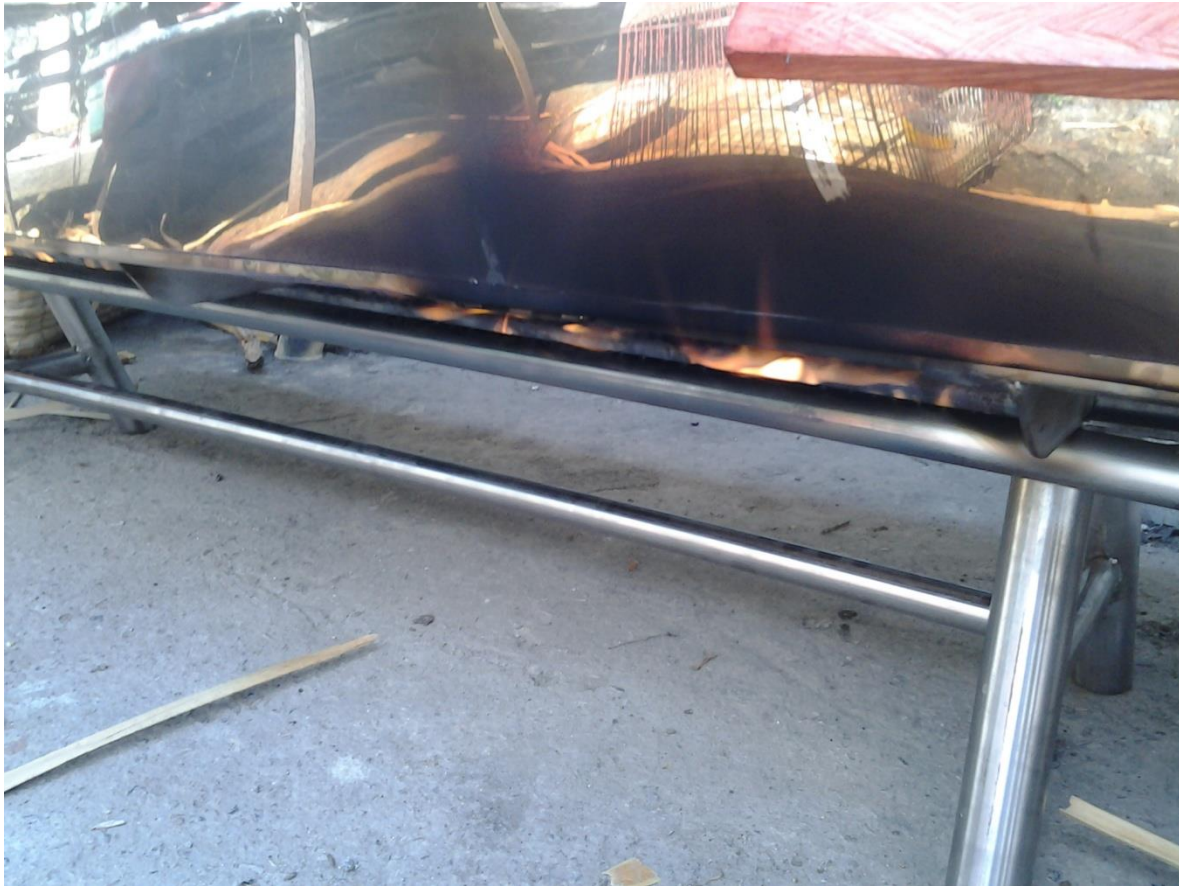
Los quemadores de gases en la tina terminada. Fuquene Foto tomada por Constanza Arévalo 2014
