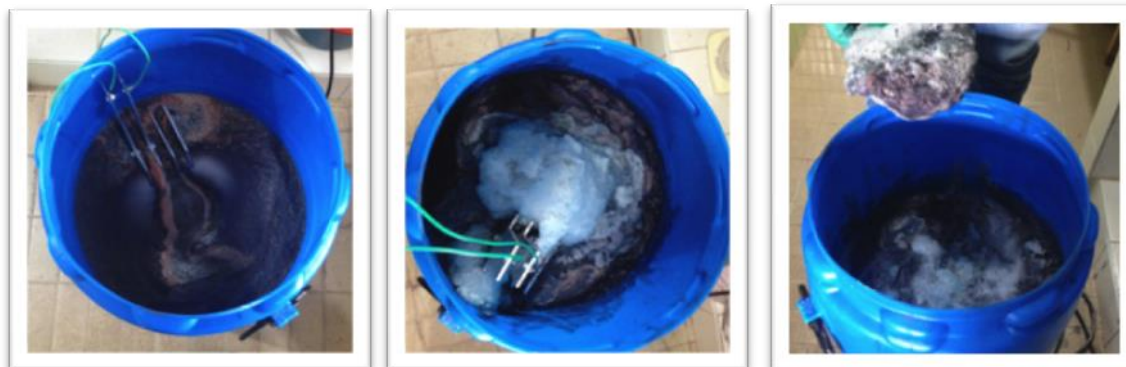
Imagen 9 Proceso de tratamiento por electrocoagulación (Diciembre de 2014) Fotografía: Fluvia – Hydrocloro Technologies SAS
