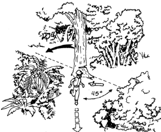
Fig. 22. Construcción de la ruta de escape Fuente: Manual de Motosierras FAO/PER/78/ 003
