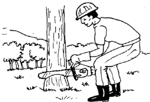
Figura 24. Cuando el largo útil de la barra es mayor que el diámetro Fuente: Manual de Motosierras FAO/PER/78/ 003
