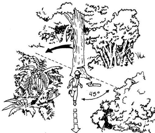
Fig. 22. Construcción de la ruta de escape
