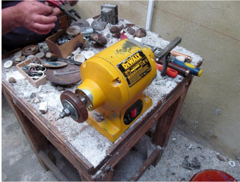
Maquinas adaptadas para tornear las taguas.
