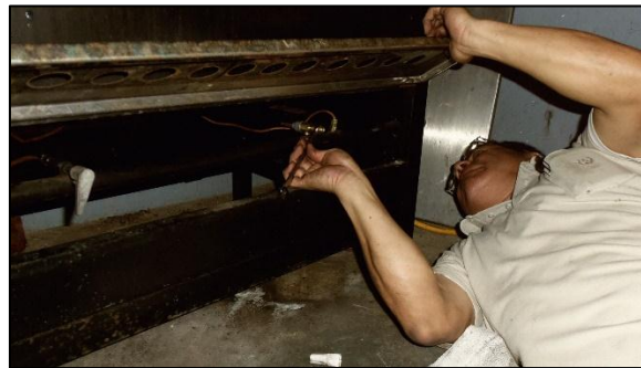
Arreglo del piloto del equipo de tintura que existía en la comunidad Guacamayas, Noviembre de 2014 – Omaira Bautista Fagua Cedavida – Artesanías de Colombia
