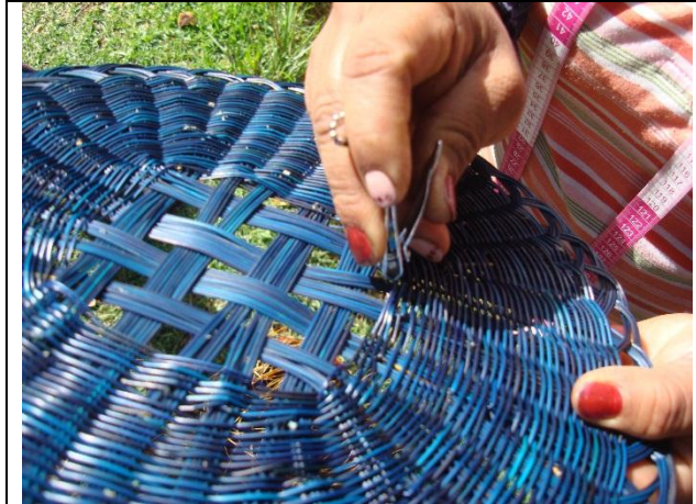
Implementación de cortaúñas para remates. Jennibeth Iguaran Artesanías de Colombia S.A. – Fundación Social Colombiana CEDAVIDA Ráquira, Boyacá, Noviembre de 2014
