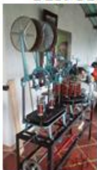
Trenzadoras mecánicas para la elaboración de trenzas y cordones.
