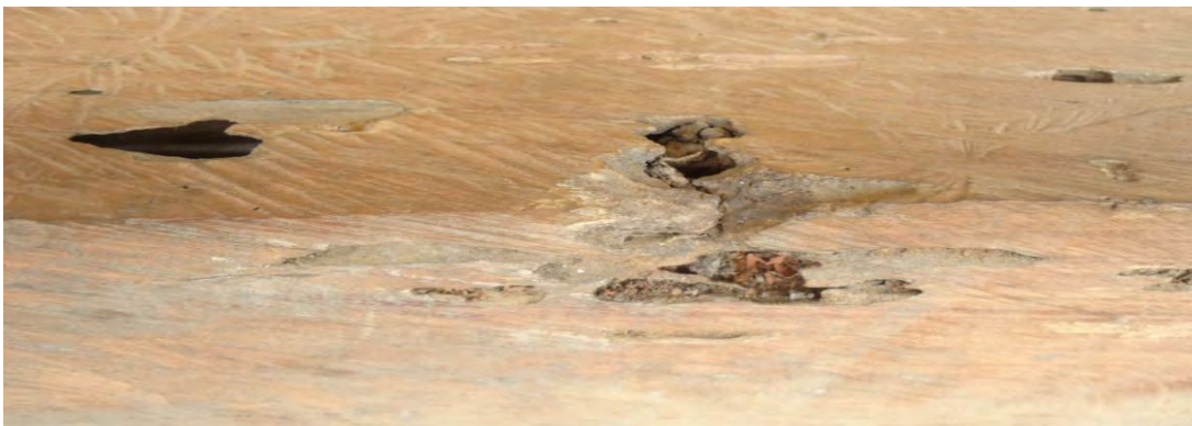
Foto 19. Afectación en las trozas de palosangre por pudrición del tallo, Puerto Leguizamo, Enero 2015, Fundación Cultural del Putumayo, Artesanías de Colombia.
