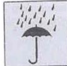
PROTEGASE DE LA HUMEDAD
