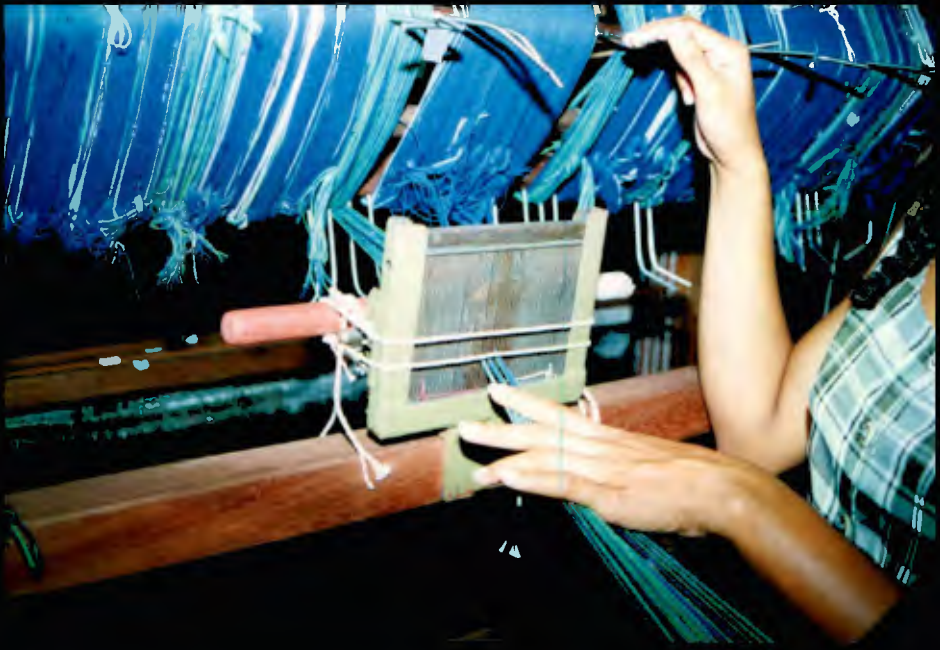
133 19.13.041 TEJEDURÍA, HOR. BOLIVAR, SAN JACINTO CARRO GUÍA SECCIONES URDIDO COOP. ASOC. COMIT.
