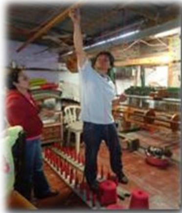
*Fotografía 9. Fileta y paso de los hilos por el portahilos*
