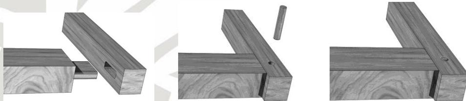
Es costumbre asegurar la junta en espiga y caja, con un tarugo en el larguero de tal manera que atraviese la espiga, este tarugo es un componente a la vista, no es aceptable el uso de puntillas para asegurar las espigas.
