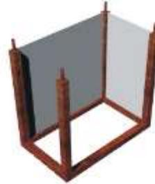
6. Insertar la lámina 2 en la canal entre los soportes verticales
