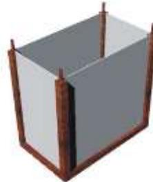
8. Insertar la lámina 4 en la canal entre los soportes verticales
