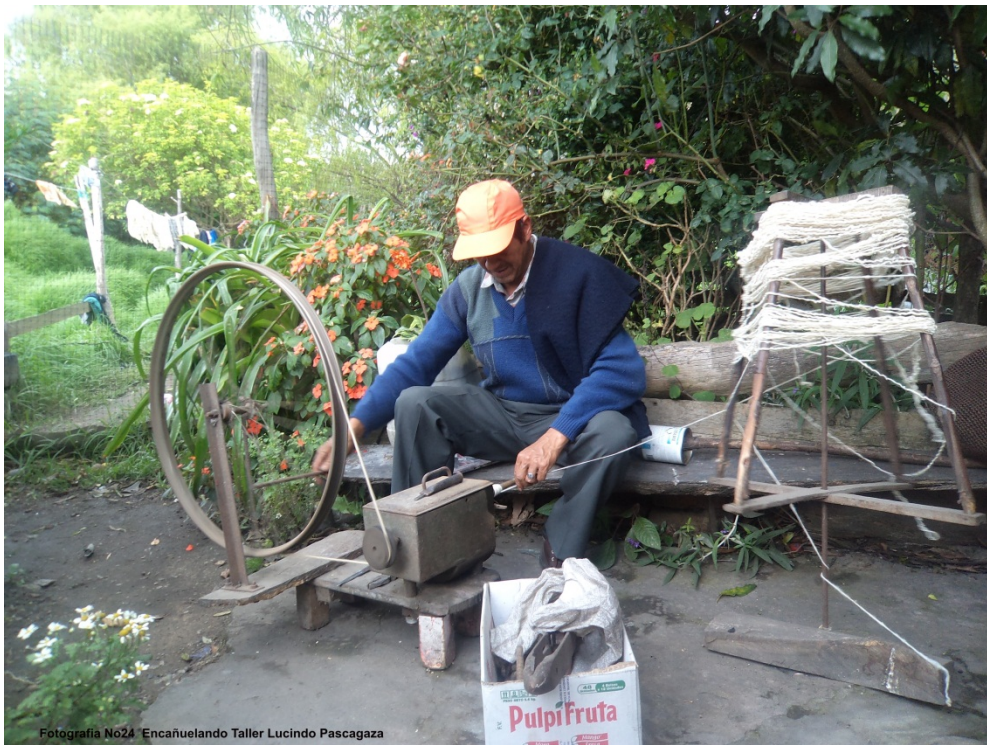
Fotografía No24 Encañuelando Taller Lucindo Pascagaza
