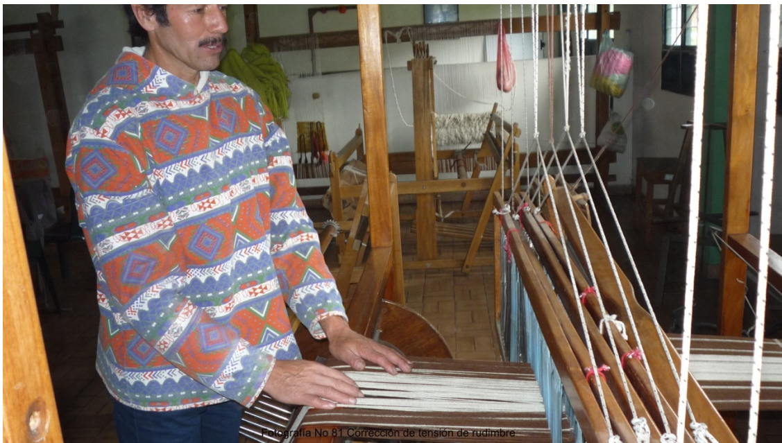
Fotografía No 81 Corrección de tensión de urdimbre
