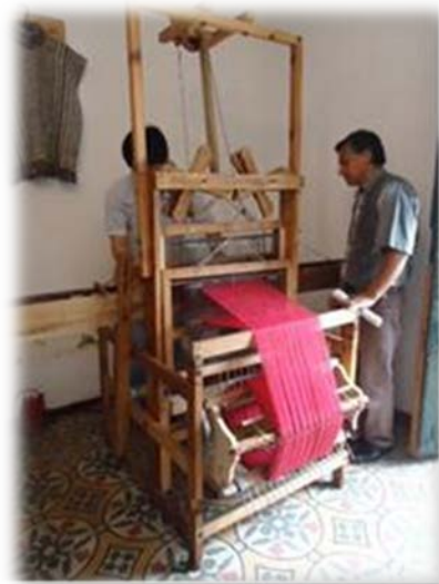
Fotografía No 5 Telar con levante de espadas
