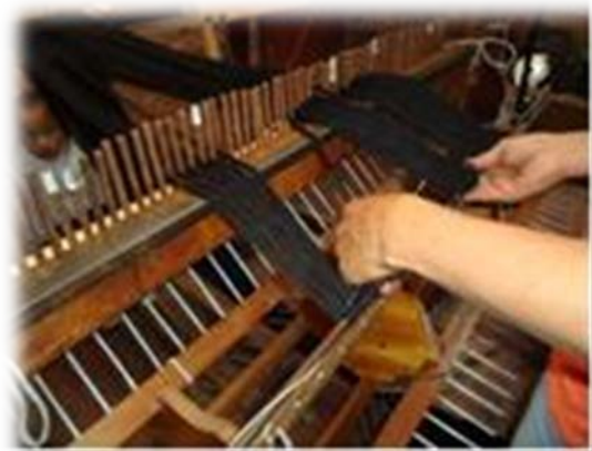
Fotografía No 14 Montaje a partir de urdido por urdidera
