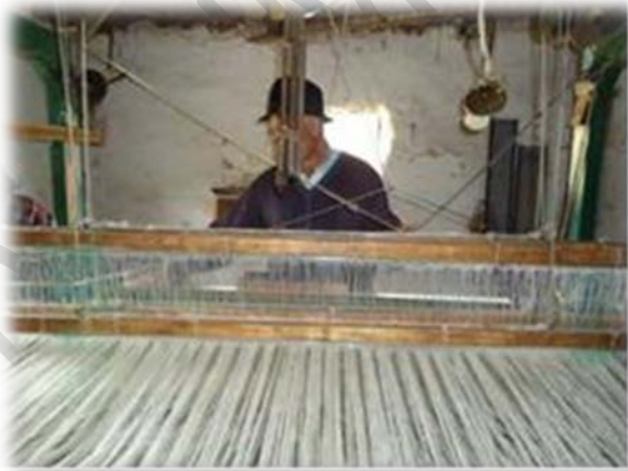
Fotografía No 4 Telar con levante de poleas
