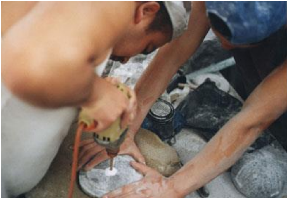
Fabricación de la pieza en sal para el reloj, en la fotografía se presenta una de las etapas de perforación para la instalación del mecanismo
