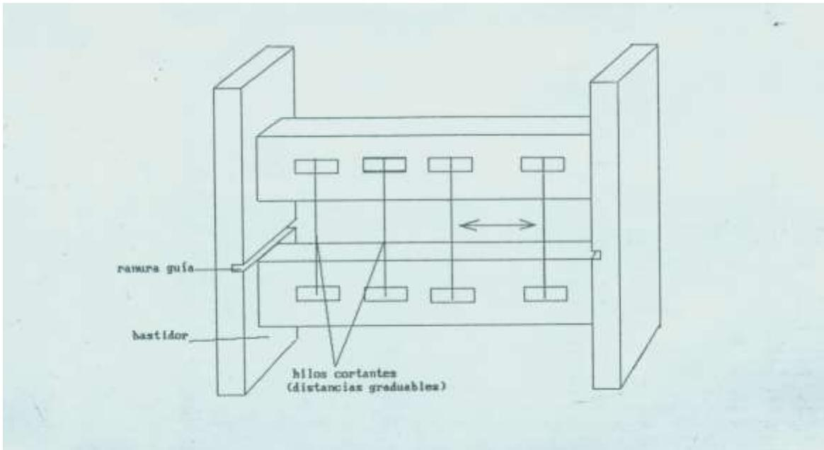
Esta herramienta consta de un bastidor sobre el cual se disponen hilos cortantes de metal cáñamo o nylon, a distancias graduables.
