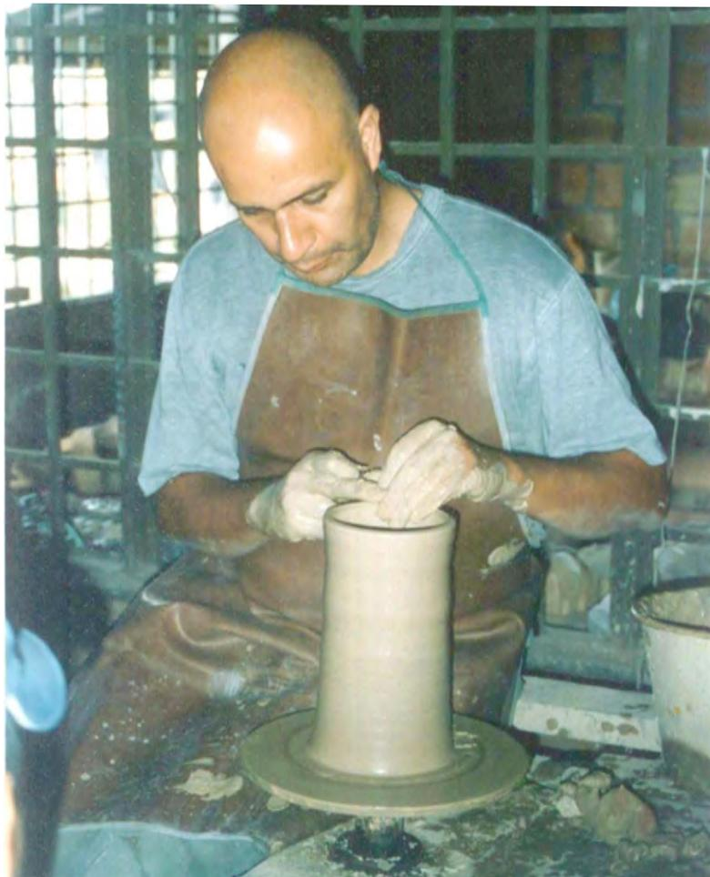
Asesor en demostración del torno de patada Coop de artesanos del Huila
