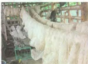
Luego se colocan las madejas a secar, generalmente en un área cubierta y sobre un material que no desprenda impurezas para evitar que se dañe la calidad de la seda. Por último se pesan en el balanzón y se anota el peso para desgomar
