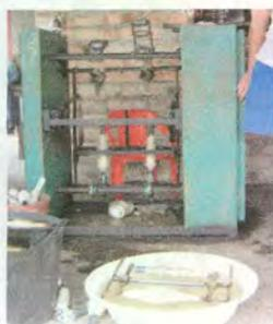
Se toman dos filamentos se pasan por la retorcedora o hiladora para realizar el entorchado. Tener en cuenta que la tensión de los dos filamentos sea igual, que no haga bucle para evitar enredos.
