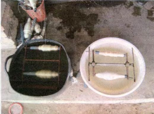
Pruebas de lubricación de materia prima por imersion - proceso de torsión de fibra, aditivos suavizantes de fibras.
