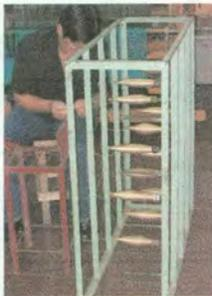
Colocamos las cañuelas en la filleta, para determinar los diseños por colores y cantidad de hilo a urdir. Así como para facilitar el desempeño del hilo en el proceso de urdido (tension).
