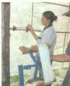
Se retiran los usos de la retorcedora y se hacen las madejas de unos 100 grs para evitar enredos en el proceso de desgome o tinturado (retirando las impurezas como hilaza para que el hilo quede limpio) para este proceso se utiliza herramienta manual denominada madejero Los amarres o cruces deben ser de 4 a 6 flejes.
