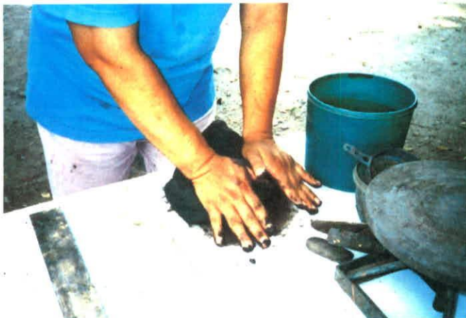
Práctica y demostración de la forma de amasado con las palmas de las manos para evitar introducir aire a la pasta cerámica.
