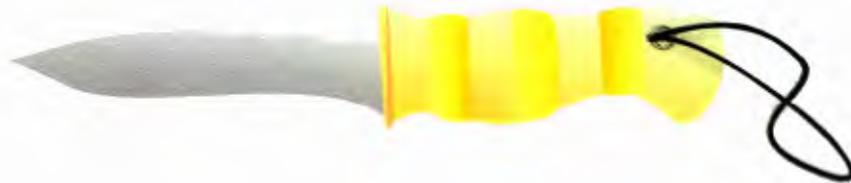
Herramienta de corte para el desvarite que consiste en separar la nervadura central de las hojas para esta actividad se propone ésta herramienta teniendo en cuenta que el artesano empieza a separar la fibra con la punta de la herramienta y continúa el corte.
