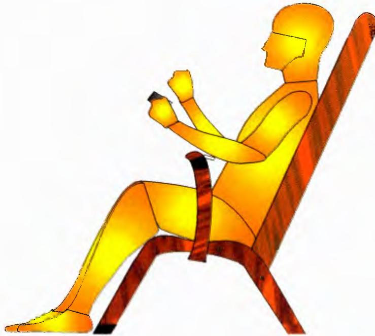
El mismo puesto de trabajo propuesto para el trenzado es funcional para la actividad de raspado en el que se puedan desarrollar además una base de apoyo donde se retira la capa vegetal de la fibra, debe estructurarse de tal forma que sea resistente y que se adapte fácilmente a piso irregular.
