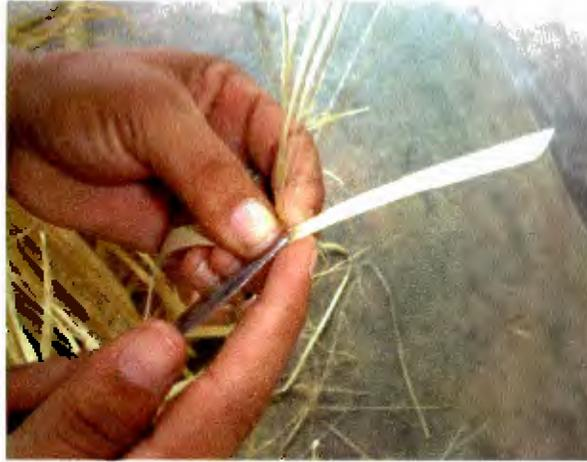
Proceso en el que presenta problemas de producción en cuanto a la calidad de de la materia, no hay homogenización de la fibra, esto puede hacer que se obtengan fibras de diferentes dimensiones que pueden ser utilizadas para un mismo producto, es un proceso dispendioso y determinante del calibre de la
