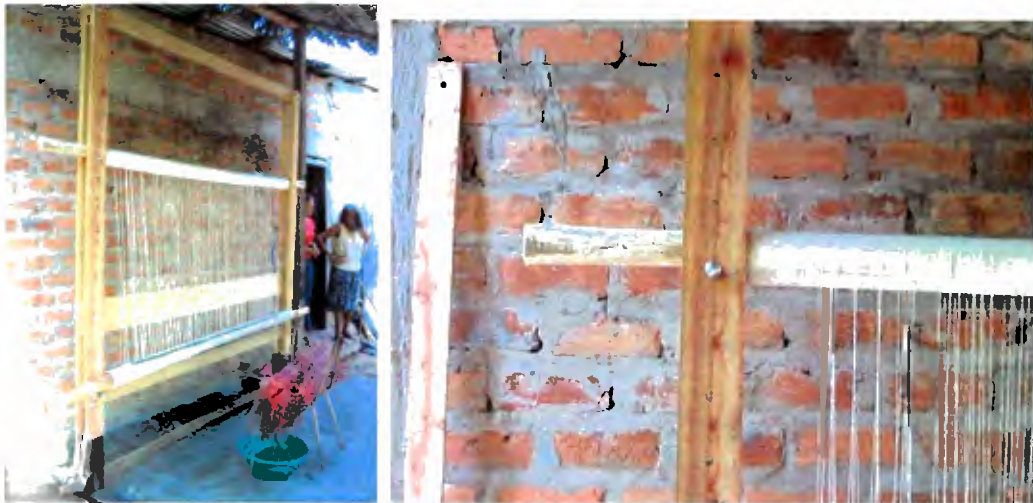
Telar de 2.0 x 2.50, sistema de graduación de tamaño de la urdimbre, fijación por medio de tornillos, y mejoramiento de material de la herramienta
