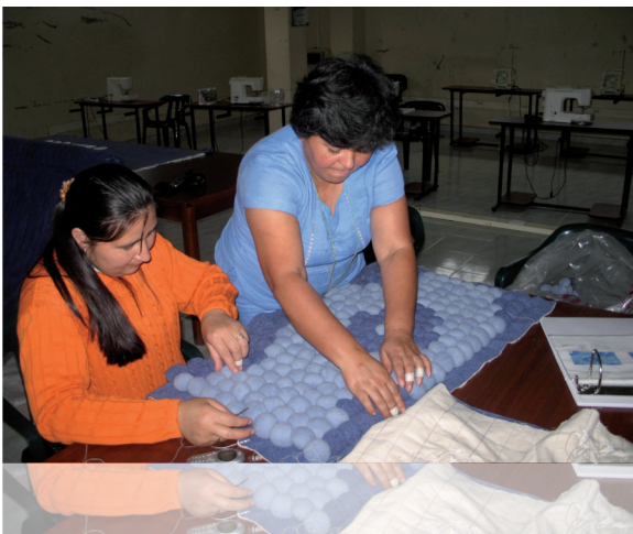
Corte y fijación de las entretelas de la base del tapete, para lo cual se utiliza material antideslizante.
