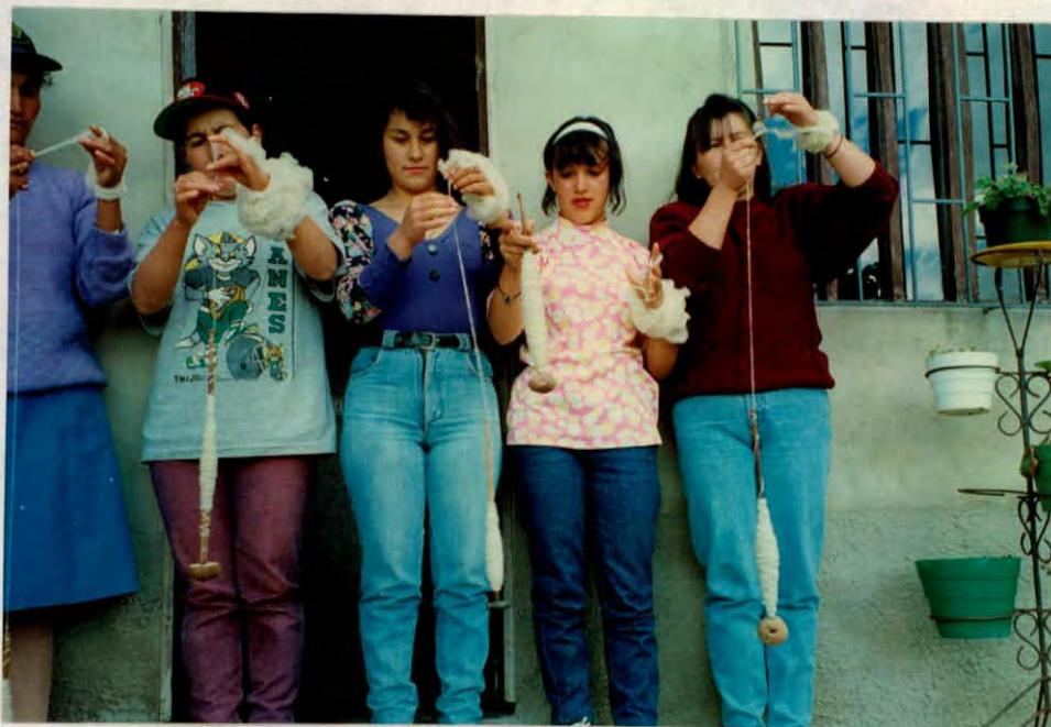
El hilado consiste en torcer y estirar la fibra, para formar una hebra esto se logra mediante la rotación del huso.
