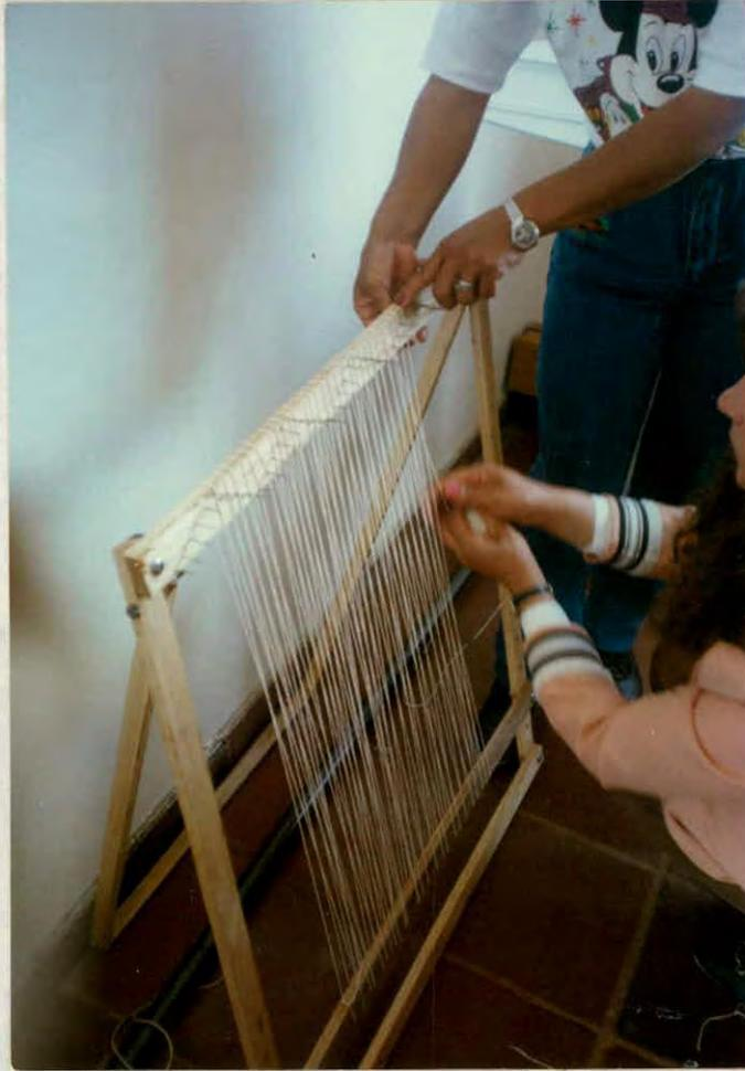
a urdimbre, base y fundamento de toda tela no es otra cosa que un conjunto de hilos que se extienden verticalmente y sostiene el tejido; este va en hilos más resistentes a los de la trama.
