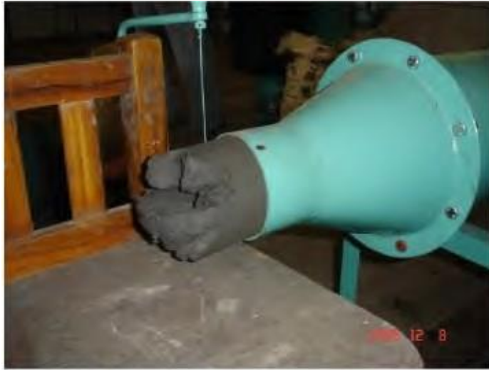
Secuencia de salida de la pasta lista paTa modelado. Fotos Jaime Martinez
