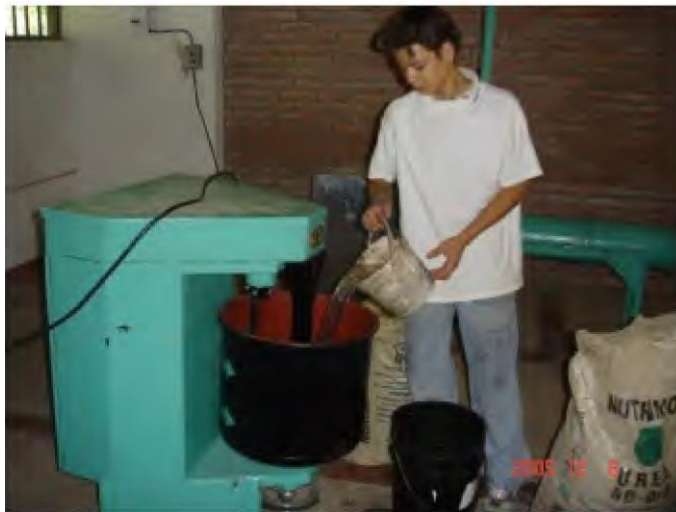
Cargue de agua a la mezcladora. Fotos Jaime Martínez
