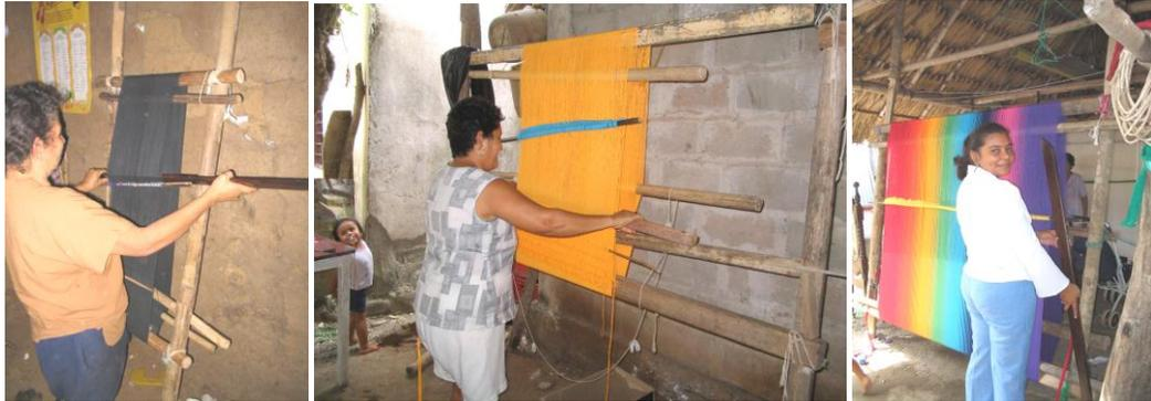
Se utiliza una paleta de madera la cual afirma el hilo de la trama, por cada hilo se realiza un paleteado. Cuando el tejido es ancho el paleteado se realiza en dos fases, abarcando la mitad del tejido por paleteado o fase. Cuando se realizan tejidos en telar de "Fajon" el paleteado se realiza en una sola fase y con una paleta de menor tamaño (o accesorio similar) dependiendo del fajón o reata que se este tejiendo.
