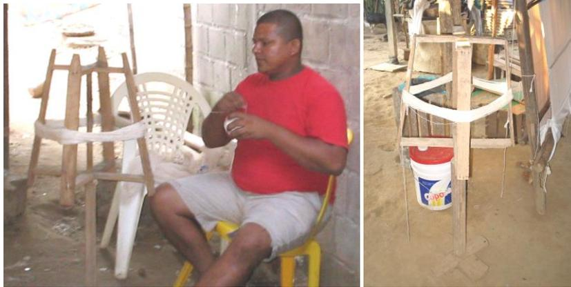
Una vez se han encolado y secado las madejas de hilo se procede a devanarlas manualmente, procedimiento al que las artesanas denominan embolar, con el fin de colocar el hilo bolas que permitan un armado o urdido rápido, pues las madejas no son de fácil manipulación.
