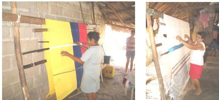
Para el proceso se utiliza un palito o lanzadera máximo de un metro, el cual llena de hilo para tejer la hamaca. Este se va cruzando entre la urdimbre realizando el paleteado.
