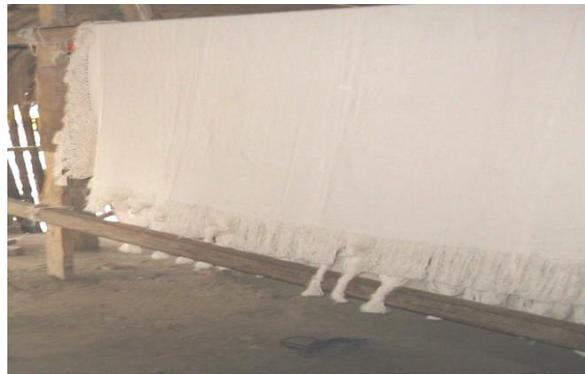
Una vez obtenido el largo deseado, se le hace el acabado con una cadeneta en los extremos superior e inferior del tejido. Después de esto se saca el producto del telar, obteniendo una sola pieza, de donde se desprende unos hilos.
