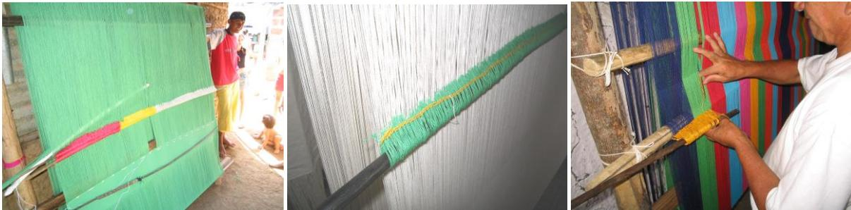
Finalizado el urdido se procede a elaborar el peine, que es hecho con un hilo el cual separa los hilos del armado para que pase la lanzadera o el palito de la tejeduría (trama). Se realiza con dos varillas e hilo adicional el cual se cruza por medio de las capas que tiene el echado y se toma una de estas, cogiendo hilo por hilo y entrecruzándolo dentro de las varillas.
