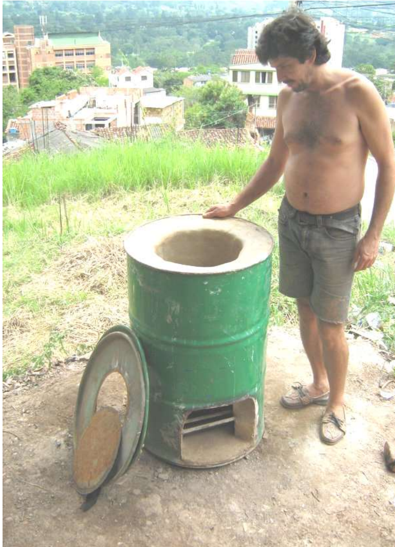
Horno de caneca totalmente terminado y listo para su uso Foto: Diego Añez
