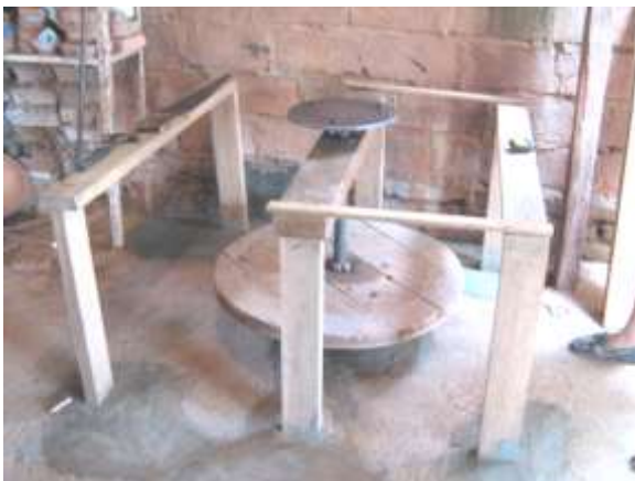
Instalación de sistema, discos y eje Foto D.Añez
