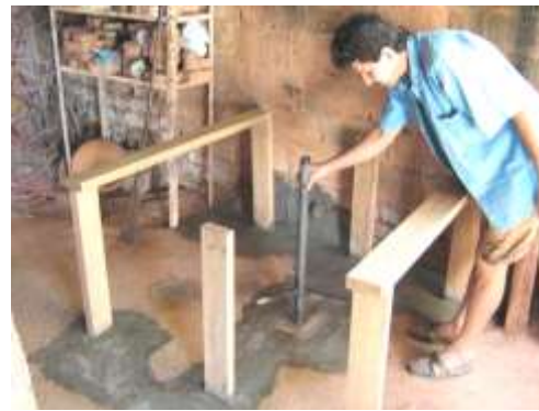
Postura de eje metálico sobre rodamiento Foto D.Añez
