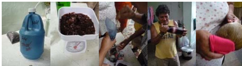
Preparación de gomalaca disuelta en alcohol industrial y aplicación – Fotografías Diego Granados – Artesanías de Colombia 2013
