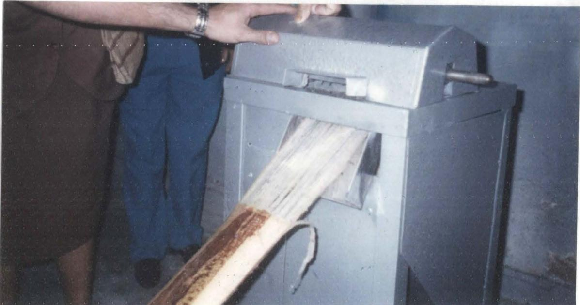
DESPUES DE EXTRAIDA LA CALCETA SE VOLTEA POR EL OTRO EXTREMO Y SE REPITE LA OPERACIÓN HASTA LOGRAR UN DESPULPADO GENERAL A LO LARGO DE LA CALCETA. TODOS LOS DESPERDICIOS SOLIDOS Y LIQUIDOS SON DESECHADOS POR LA PARTE DE ATRAS DE LA MAQUINA LO QUE FACILITA SU RECOLECCION PARA SER UTILIZADO COMO ABONO.
