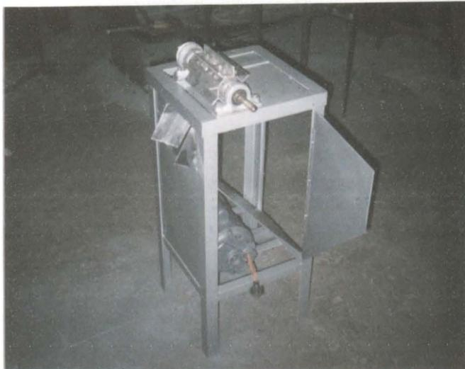
SE INTRODUCEN LAS CALCETAS POR EL ORIFICIO- BANDEJA FRONTAL DE UNA FORMA CONTINUA PARA EVITAR QUE SE ATORE CON CALCETAS MUY GRUESAS O DURAS.
