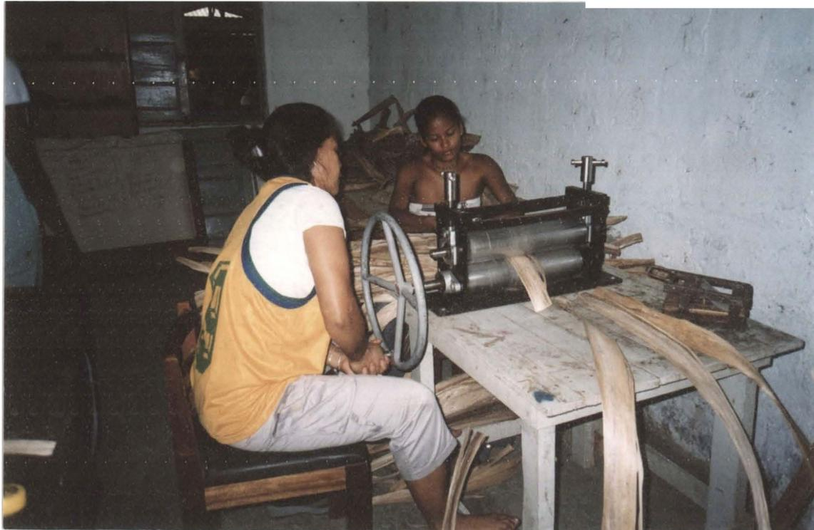
PROTOTIPO DE MAQUINARIA PARA EL DESFIBRADO DE LA CALCETA DE PLATANO DESARROLLADO EN EL LABORATORIO COLOMBIANO DE DISEÑO DE ARMENIA.
