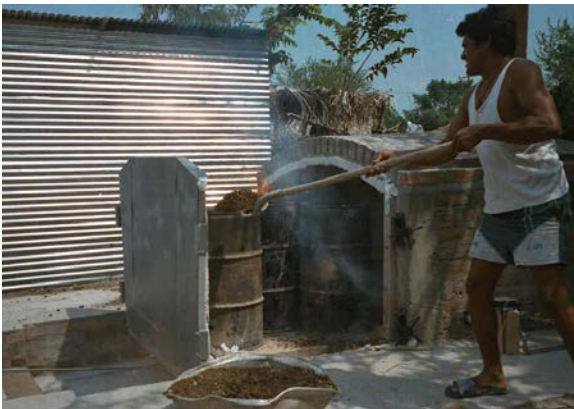
Descargue del horno y negreado
