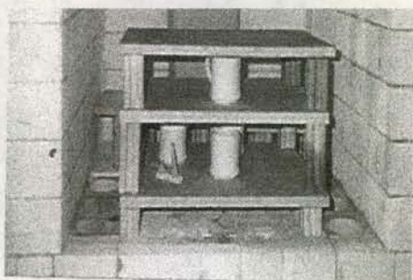
Foto 20. Columnas y placas refractarias
