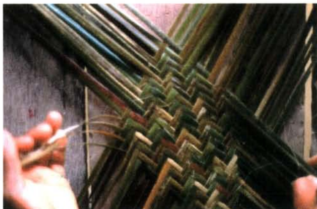
Proceso de "destajereo" del bejuco e inicio de entrecruces para formar las bases de una petaca
